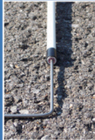
ÉTAPE 3 Entrer l'équerre à l'extrémité du winder pole
