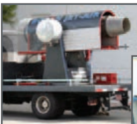
TEST AU VENT À L'AIDE D'UN MOTEUR D'AVION À RÉACTION À GRANDE VITESSE
